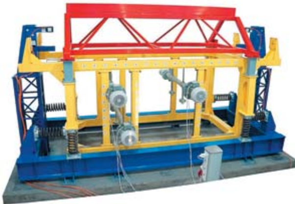
Рис. 2. Общий вид вибростенда и размещение вибровозбудителей
