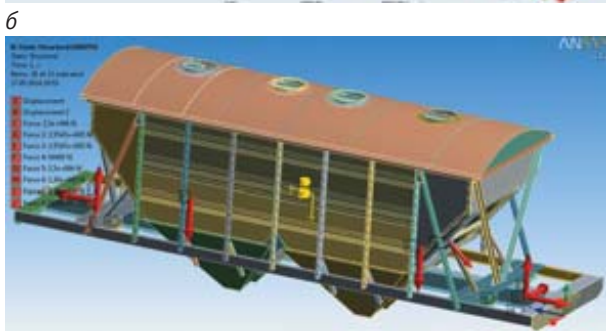
Рис. 3. Кинематические и силовые граничные условия при сжатии (а) и растяжении (б) кузова вагона-цементовоза
